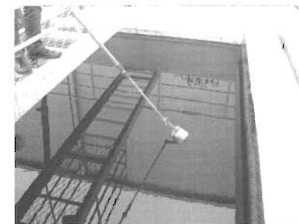
Slika 3. Uzorkovanje otpadne vode iz sedimentacionog bazena
